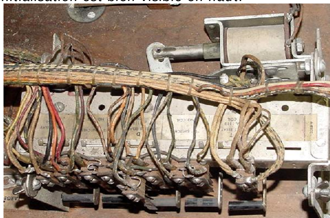
Rangée de relais Gottlieb (Flipper "Parade"), qui abrite 5 petits relais. La bobine de réinitialisation est bien visible en haut.
