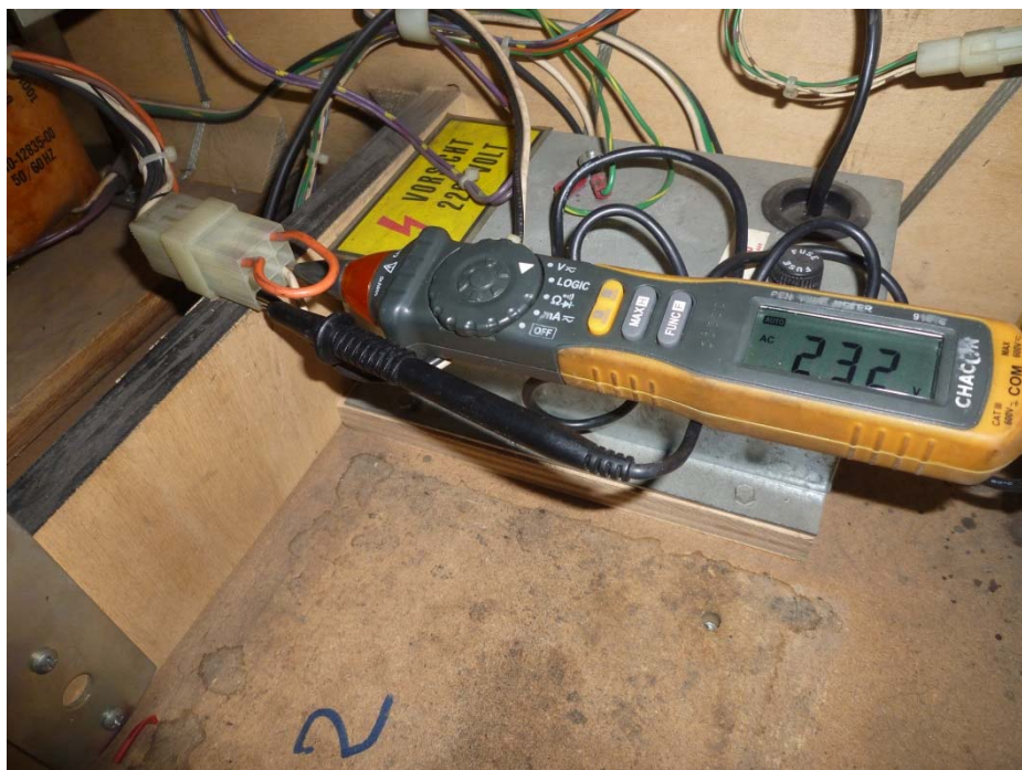
Mesure de la tension secteur dans le flipper (entre les fils blanc et noir 232V AC)
