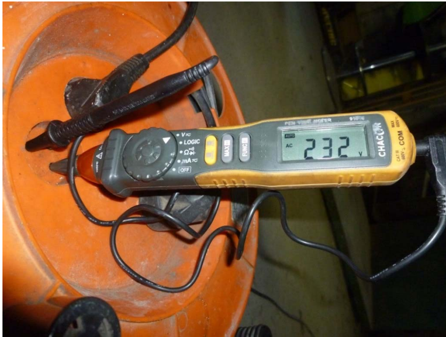
Mesure de la tension secteur sur la rallonge (232V AC).
