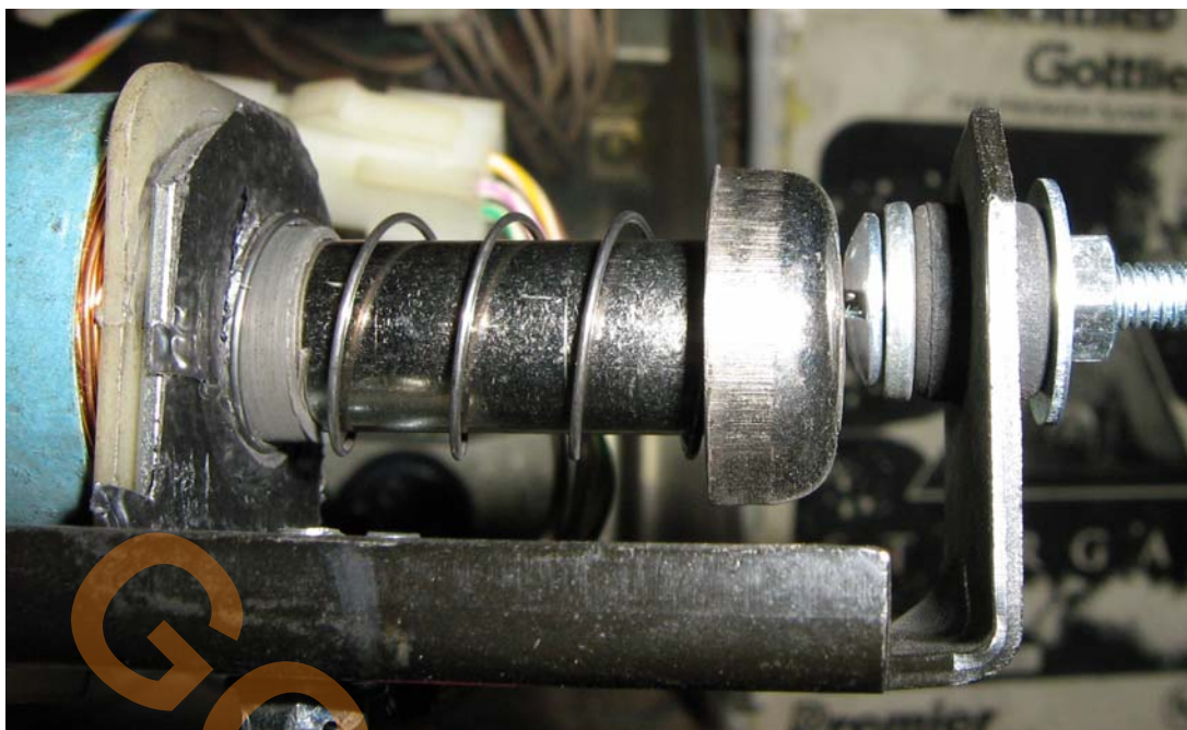
La vis et les rondelles rajoutées dans le passe-fil rehaussent le plongeur
